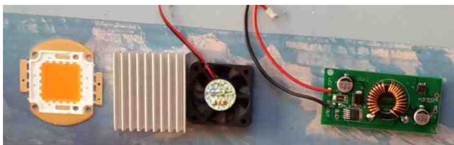
Afb. 3 v.l.n.r.: LED-chip, koellichaam, ventilator en driver
